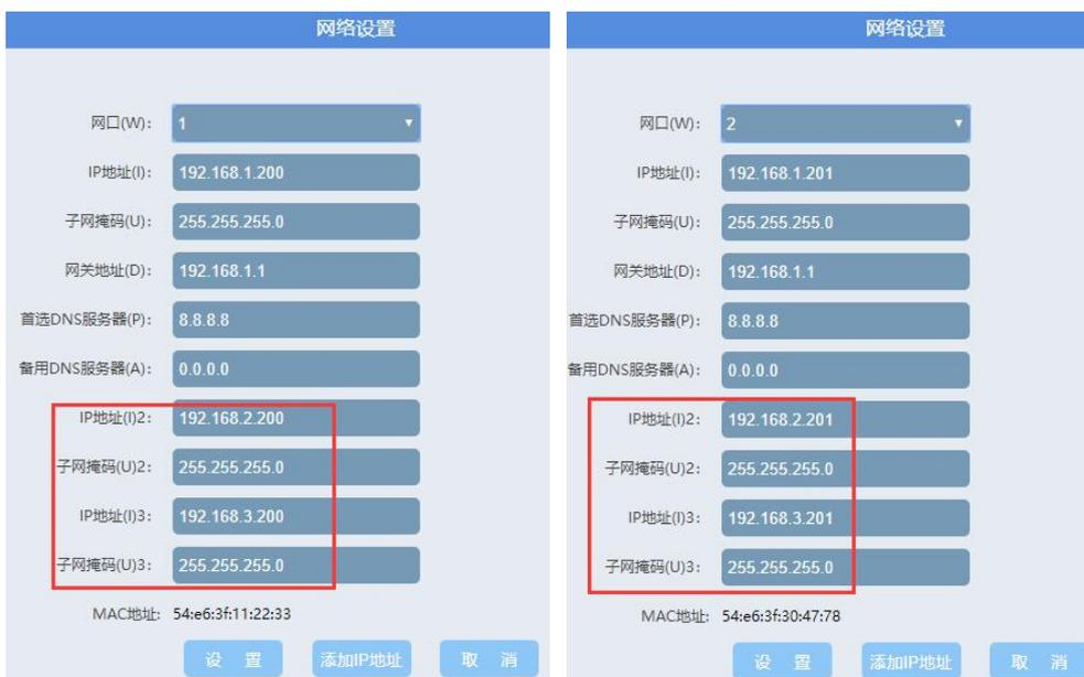
若局域网内有多个网段且没有核心交换机分配 VLAN 情况下，则可以点【添加 IP 地址】按钮，为矩阵配置多个网段，统一改完后，点设置键，矩阵会自动重启，重启完成后重新登陆。
