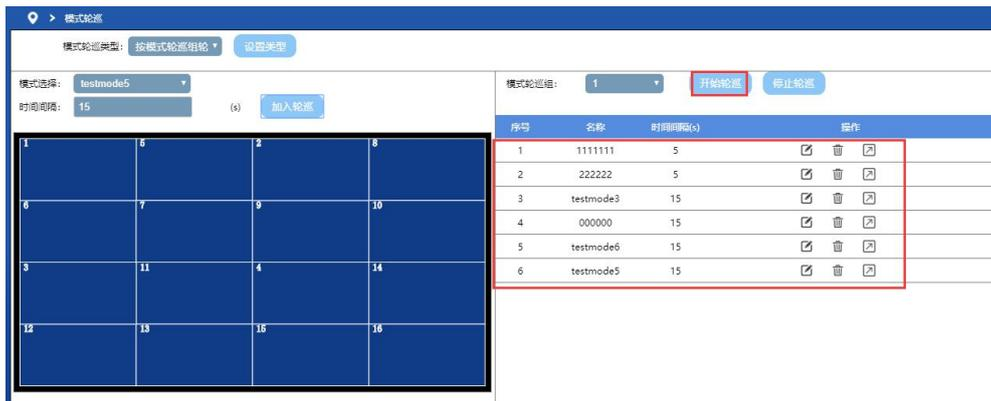
在右边框内可以看到已加入轮巡的列表，如不需要可进行修改或删除操作，确认无误后，点击开始轮巡，矩阵即按照设置好的模式轮巡列表进行模式轮巡，点击左边快捷菜单【中控首页】按钮，返回主操作界面。
