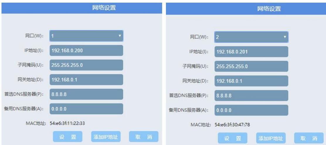
多路数矩阵在【网口】下拉列表中可以看到其它卡的 IP，如摄像机所在网段为 1 段，矩阵所有卡都要改成 1 段，且不能有 IP 冲突（改 IP 前可以先拼下有没有占用），如下图：
